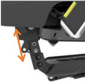
Die gewünschte Höhe einstellen und mit der Lochposition ausrichten. Die zuvor entfernten Schrauben wieder anbringen.
