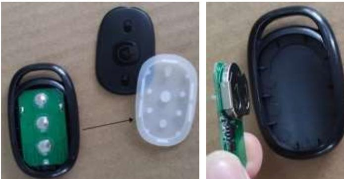
(3) Nehmen Sie die Knopfbatterie heraus, ersetzen Sie die Knopfbatterie, Modell: CR2032.
