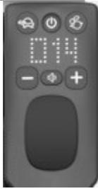
Durch gleichzeitiges Drücken und Halten des Bedienknopfes am Handgriff für ca. 3 Sekunden klappt sich das Gerät automatisch ein bzw. aus.
