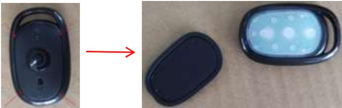
(2) Die weiße Gummischutzhülle entfernen und darauf achten, dass die Gummischutzhülle in der Nut auf der Innenseite einrastet. Dann die Platine herausnehmen.
