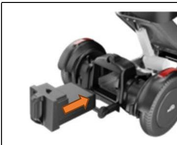
Montieren Sie die Batterie und stellen Sie sicher, dass die Batterie richtig eingelegt ist. Vor dem ersten Gebrauch die Batterie aufladen.
