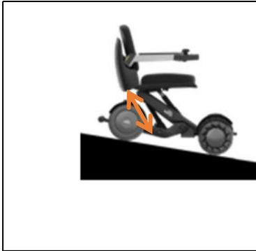
Der M4 Roboter passt die hintere Schubstange automatisch an, wenn er bergab fährt. Der Winkel des Sitzes zur Ebene bleibt dabei unverändert.
